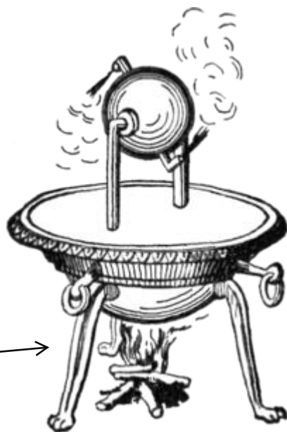
Паровая турбина Герона
